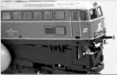
Abb. 1: Das Lokgehäuse ist mit äußerster Vorsicht abnehmbar. Da die Federpuffer leicht in den Innenbereich des Lokkastens hineinragen, achten Sie bitte beim Abziehen des Lokkastens stets auf den Lichtleiterblock.
